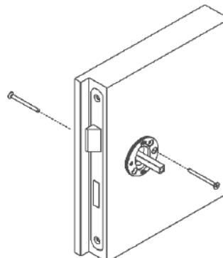
Veuillez fixer le socle de montage métallique sur la porte avec des visseuses M4 traversantes des deux côtés.
