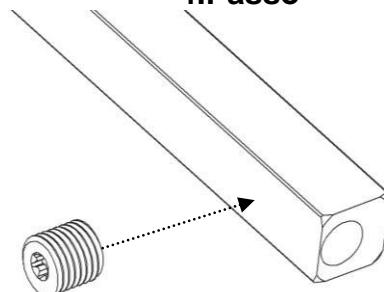
**Attenzione:** Il perno ha un foro eccentrico. Inserire il perno in modo che la punta del grano possa entrare nel punto più sottile.
