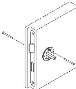
Avvitare la base di montaggio (in metallo) all'anta della porta con le viti M4.
