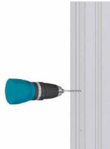
anzeichnen, ankören und vorbohren ...
